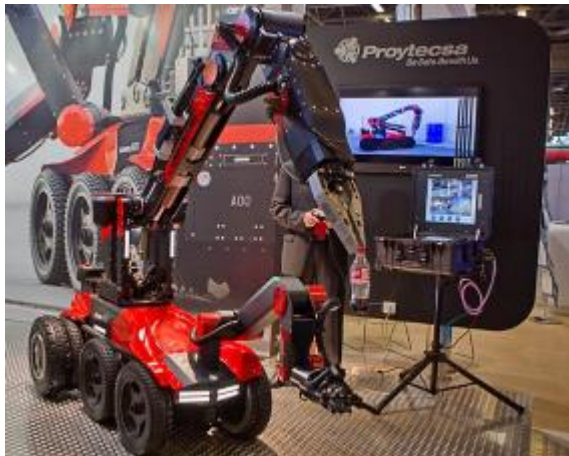
Robot de déminage à 2 bras synchronisés
