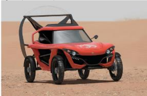
Le Pégase, buggy volant jusqu'à 3000 mètres d'altitude Vitesse : 100km/h sur terre, 60 à 80 km/h dans les airs Décollage 50 à 100 mètres, atterrissage 10 à 30 mètres
