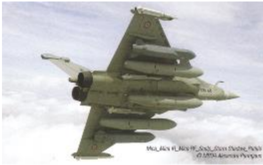
Rafale et ses missiles MICA (IR et RF), ses SCALP et STORM SHADOW
